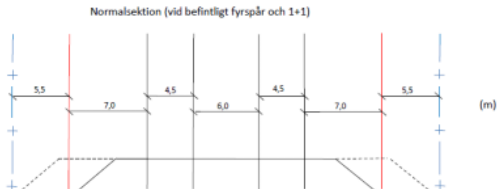
Figur 1. Normalsektion vid befintligt fyrspar. Svarta och röda linjer symboliserar spårmitt. Svarta är befintliga spår. Röda är nya skissade spår. Blått är gräns för nytt spårreservat.
