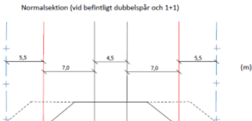
Figur 1. Normalsektion vid befintligt fyrspar. Svarta och röda linjer symboliserar spårmitt. Svarta är befintliga spår. Röda är nya skissade spår. Blått är gräns för nytt spårreservat.
