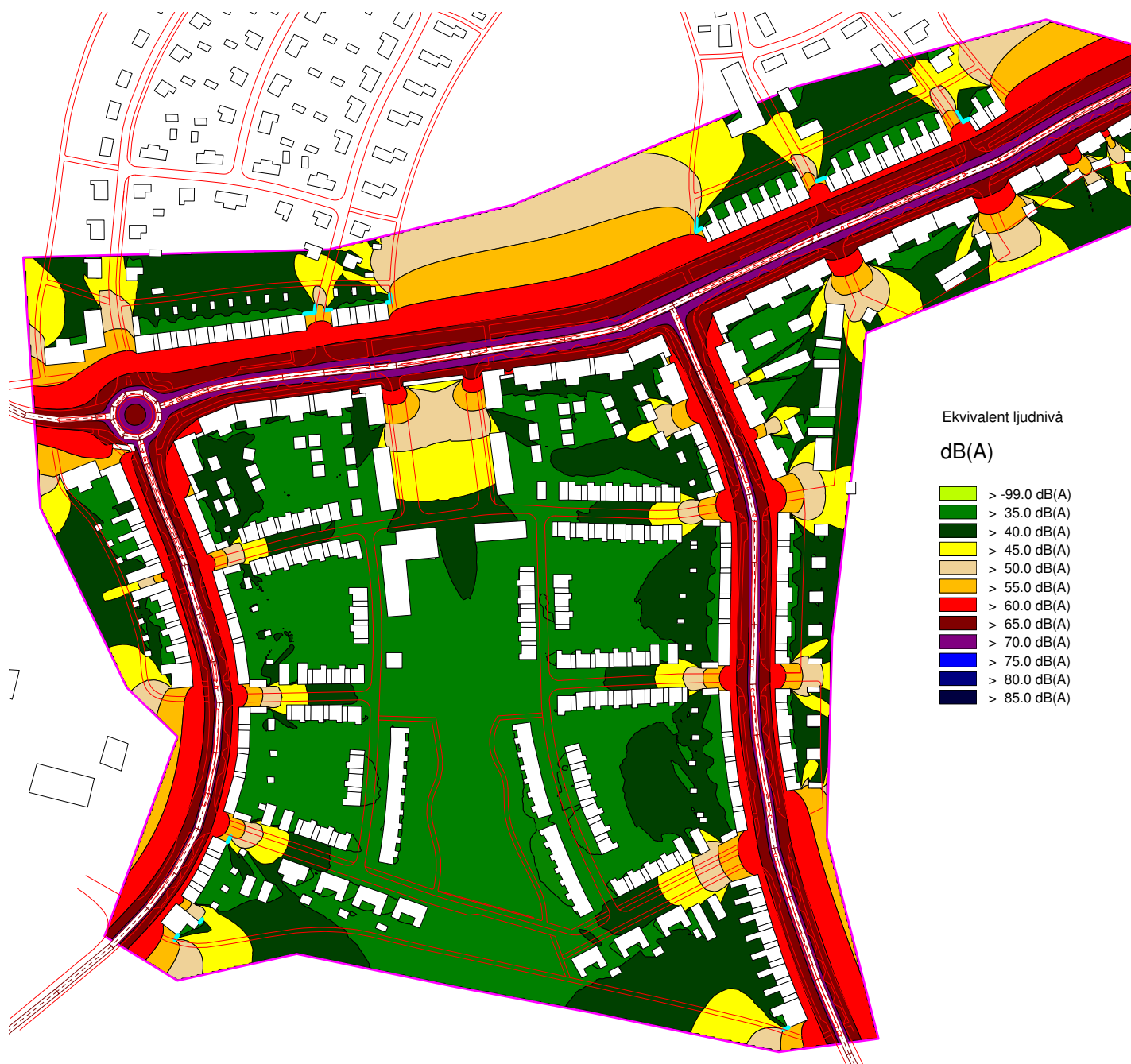
Utsnitt ur bullerkarta som visar ekvivalent bullernivå med 2 m hög skärm mellan husen. Grön färgskala innebär max 45 dBA. Illustrationen visar exempel på hur skärmar (ljusblå linjer) får placeras i småhuskvarter och icke slutna kvarters ytterhörn för att klara ljudkrav på gård (Bjerking AB)
