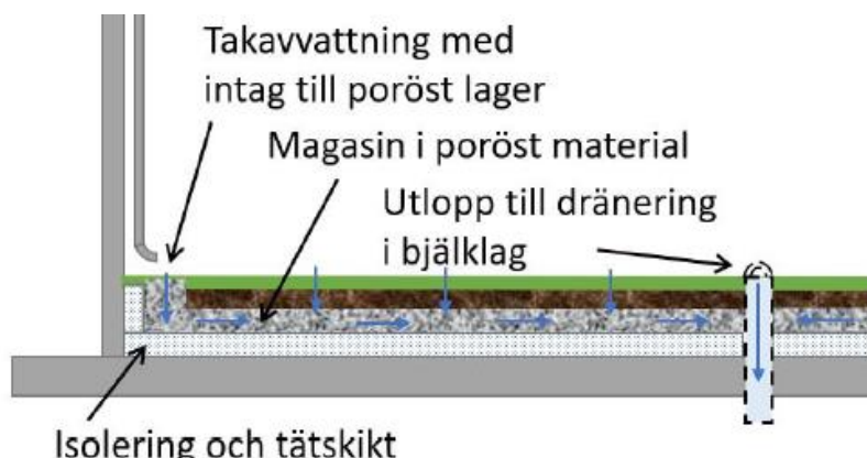
Figur 5. Schematisk skiss över ett magasin på bjälklag. Figur: WRS.
