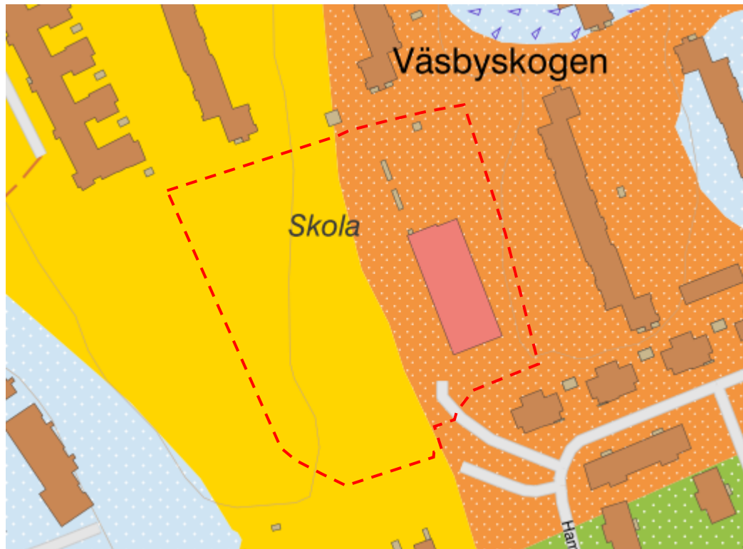
Bild 4. Jordartskartan visar att planområdet är beläget på glacial lera (gul färg) och postglacial finsand (orange). Blå färg visar morän och grön färg visar isälvs sediment. © SGU Jordarter skala 1:25 000 – 100 000.
